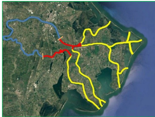
Rappresentazione della risalita del cuneo salino nel Delta del fiume Po in condizione di bassa e alta marea (in rosso) durante il mese di luglio
